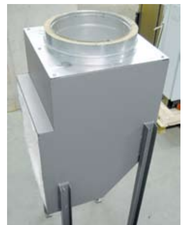
Izolowany króciec do bocznego odciągu spalin do podłączenia układu ssącego udostępnionego przez klienta
