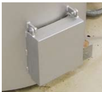
Spust awaryjny do bezpiecznego odprowadzania ciekłego metalu w przypadku pęknięcia tygla
