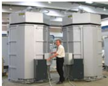
2 x S 3570/65 AS do wyżarzania ujednorodniającego
