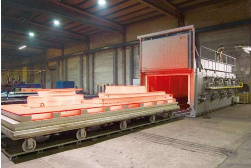
Opalany gazem piec z trzonym wysuwającym WB 14880 S do wyżarzania dużych elementów stalowych
