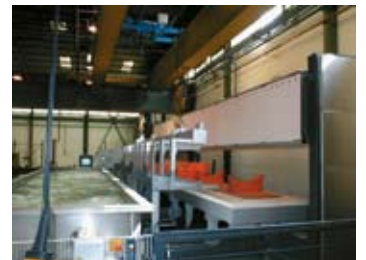
Wyjeżdżanie trzonu pieca i wsadu pod hak typu C suwnicy
