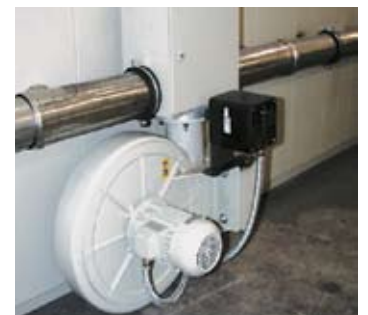
Dmuchała chłodząca skracająca czas procesu
