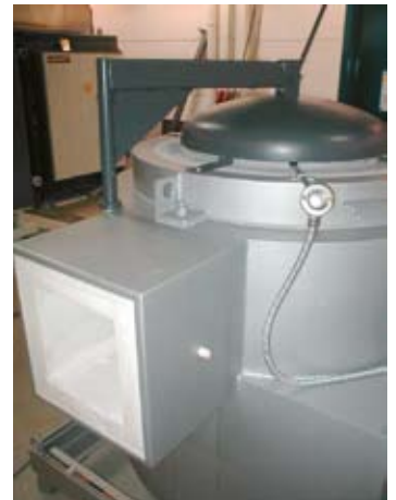
TB 80/12 z bocznym odciągiem spalin
