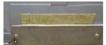
Układ sygnalizacji pęknięcia tygla pod spustem awaryjnym pieca topielnego
