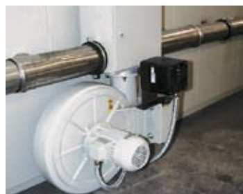
Dmuchawa chłodząca, skracająca czas procesu
