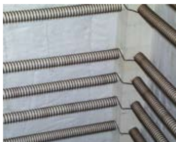
Izolacja ścian bocznych z materiału włóknistego w modelach KF
