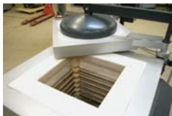
Płyta kołnierзова elektrycznego pieca tyglowego odsunięta przed wyjęciem tygla
