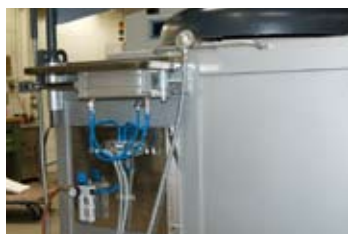
Pneumatyczny układ otwierania pokrywy
