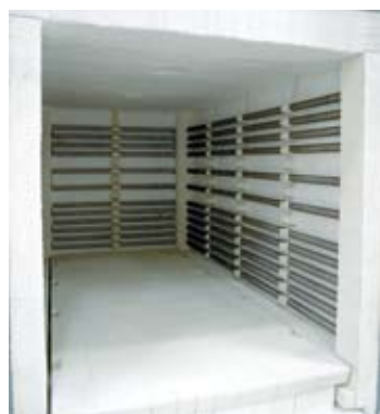
Izolacja włóknista z cegłami narożnymi w celu skrócenia czasu schładzania i nagrzewania
