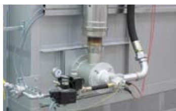
Doprowadzenie gazu z boku pieca
