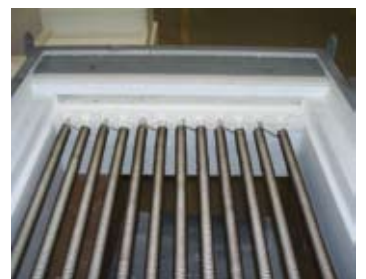
Ogrzewanie w pokrywie, łatwiejsza wymiana elementów grzejnych
