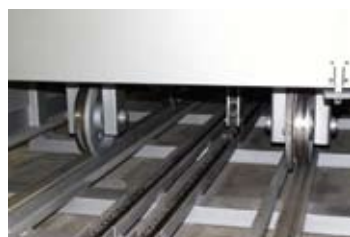
Trzon pieca z napędem łańcuchowym
