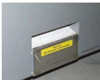
Spust awaryjny do bezpiecznego odprowadzania ciekłego metalu w przypadku pęknięcia tygla
