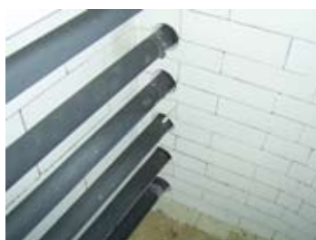
Ogrzewanie z dwóch stron za pomocą prętów z SiC o dużej mocy
