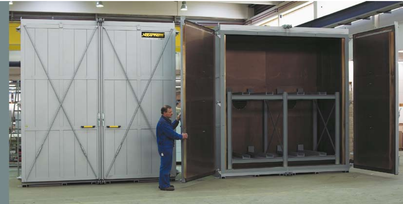
2 x N 12000/26AS z podstawami załadowniczymi do podgrzewania form
