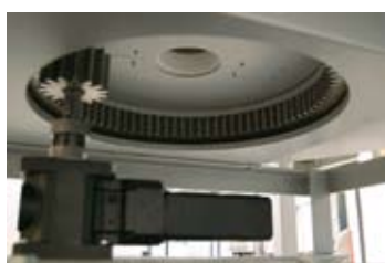
Napęd za pomocą wieńca zębatego pod piecem
