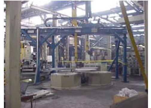
Instalacja obrotowa z piecami 3 x T 150/11
