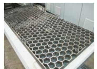
Ruszt stalowy na trzonie, do załadunku wsadu o większej masie
