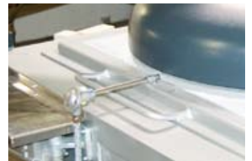
Regulacja temperatury ciekłego metalu z termoelementem w ciekłym metalu.
