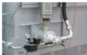
Doprowadzenie gazu z boku pieca
