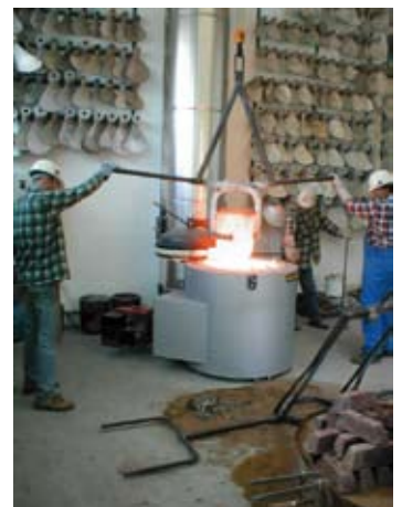
TB 40/14 z wyposażeniem do wyciągania tygla
