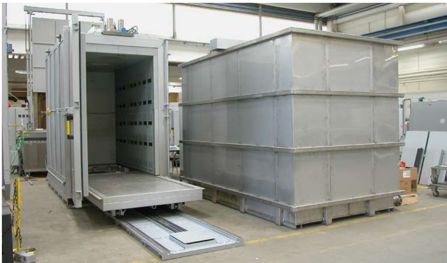
Piec z trzonem wysuwany W 7440/26 AS do wyżarzania ujednorodniającego i wanna wodna WB 24000/S do chłodzenia
