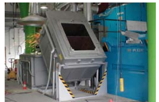
Przechylny piec topialny do magnezu K 1500/75 S o pojemności tygla 1500 litrów
