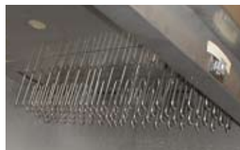
Elementy grzejne w wersji elektrycznej
