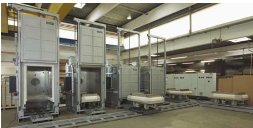
Piec z trzosem wysuwany i z urządzeniem do przesuwania poprzecznego w celu automatycznej zmiany trzonu
