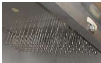
Elementy grzejne w wersji elektrycznej
