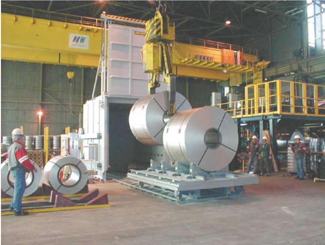
Piec W 21875/26AS z trzosem wysuwany, dostosowany do potrzeb klienta do podgrzewania zwojów blachy o maksymalnej masie 50 t
