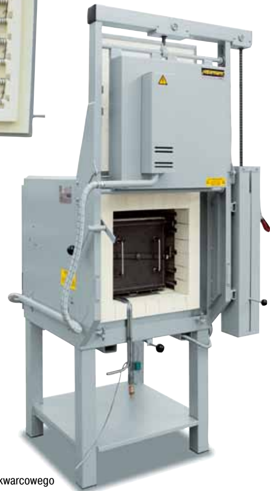
LH 60/12 z drzwiami podnośnymi otwieranymi ręcznie i skrzynią do napełniania gazem do obróbki w atmosferze niepalnych gazów ochronnych
