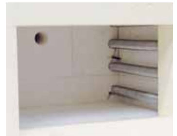
Komora pieca z izolacją z cegły ogniotrwałej o wysokiej jakości
