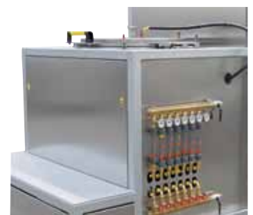
Regulacja chłodzenia wodą
