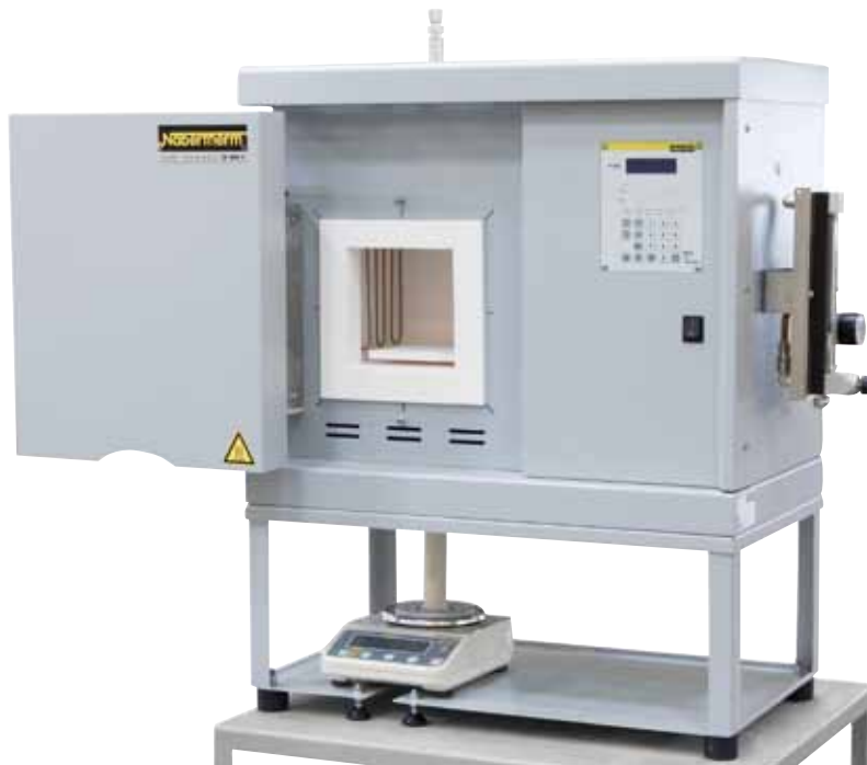
Piec LHT 04/16 SW w wersji dostosowanej do potrzeb klienta, z wagą do oznaczania strat podczas prażenia i systemem zasilania gazem
