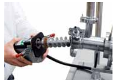
Ślimak przenośnika z regulowaną prędkością obrotową
