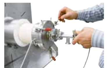
Chłodzone wodą kołnierze końcowe z szybkozłączkami jako wyposażenie dodatkowe
