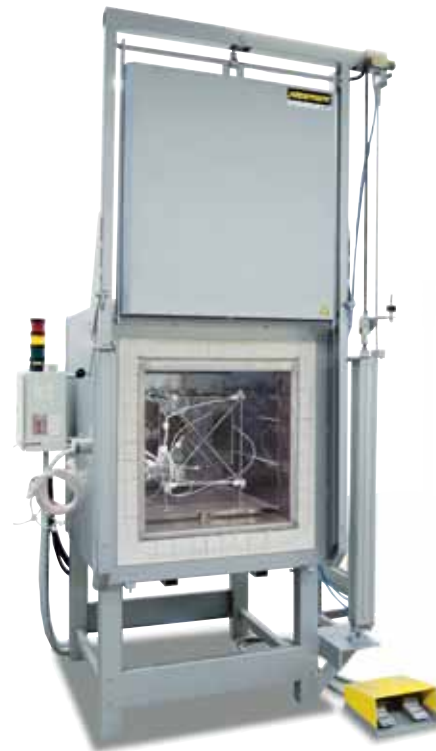
Stojak pomiarowy do wyznaczenia równomierności temperatury
