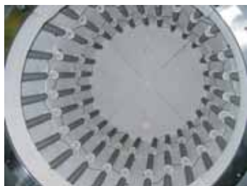
Nagrzewanie od zewnątrz wokół retorty w modelach NRA ../09 i NR ../11
