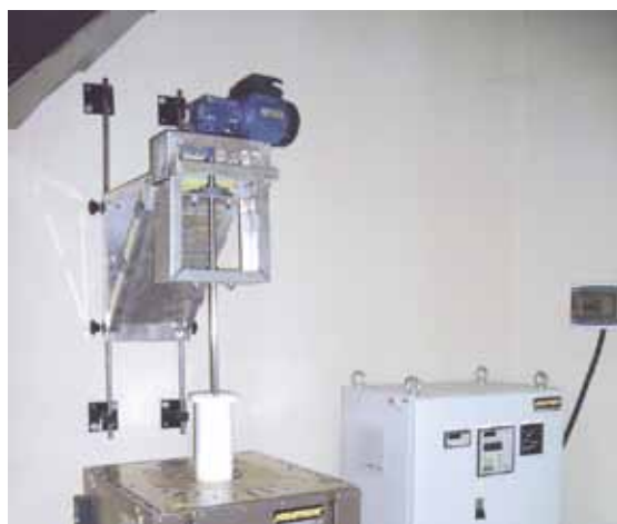
Piec RHTV 120/300/15 wbudowany w urządzenie do testów na rozciąganie
