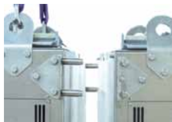
Czopy łączące dwie połowy pieca
