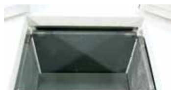
Komora pieca S 73/HS wyłożona płytami z SIC
