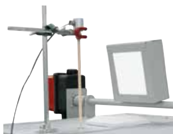
Przepustnica powietrza odlotowego i termoelement dla wsadu ze statywem jako wyposażenie dodatkowe
