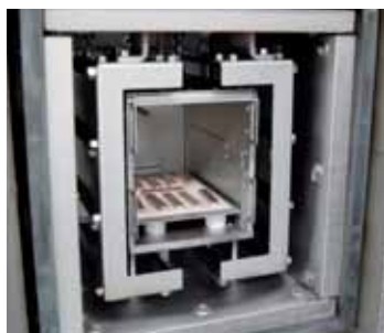
Obróbka cieplna prętów miedzianych w atmosferze wodoru w piecu VHT 08/16 MO
