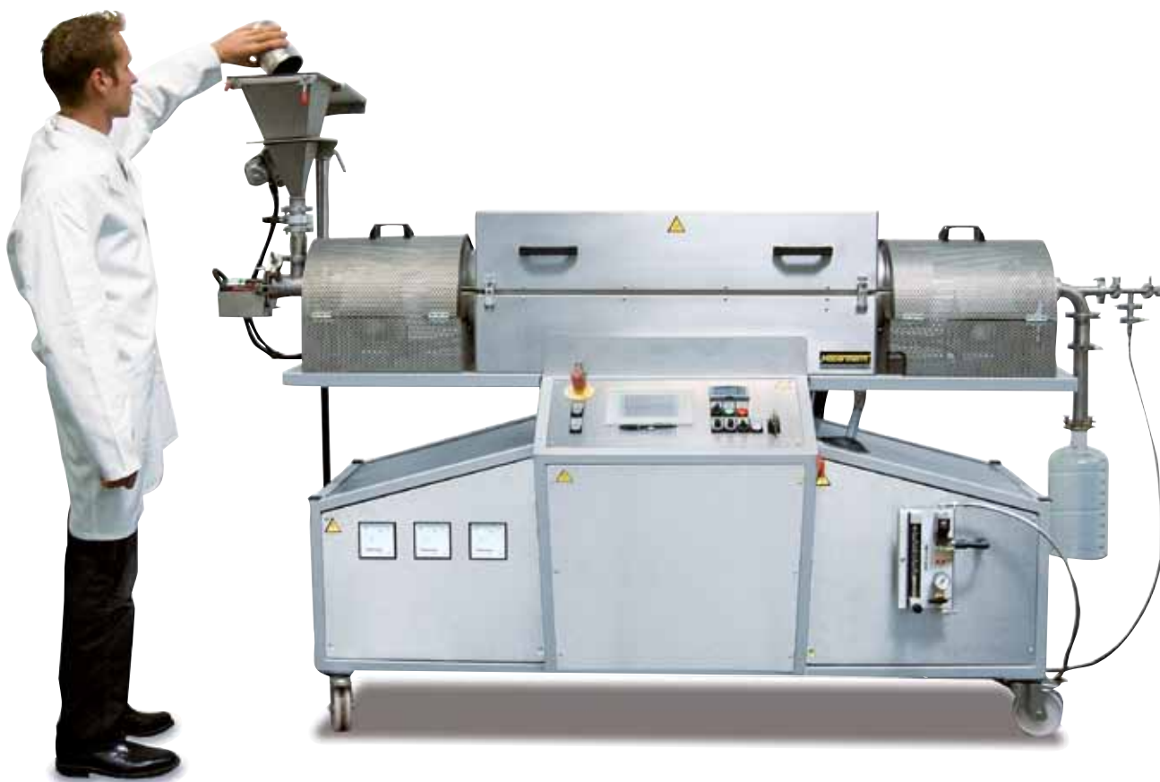
RSR-U 120/750/11 z regulowanym elektrycznie kątem pochylenia do wykorzystania w procesach ciągłych lub do pracy okresowej
