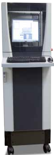
Komputer PC układu sterującego HiPro-Systems w oddzielnej szafie
