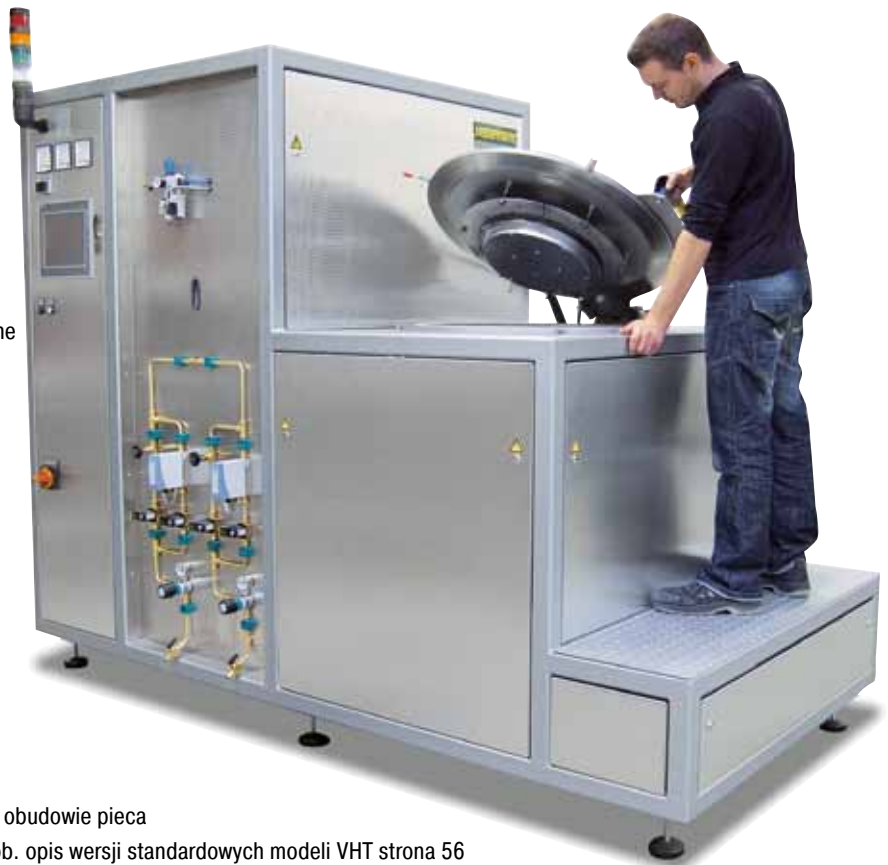
SVHT 9/24-W z nagrzewaniem wolframowym
