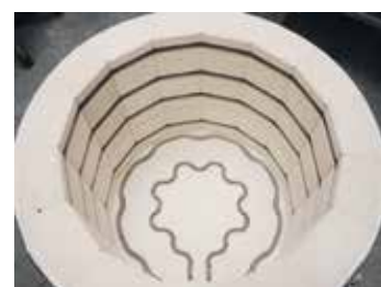
Elementy grzewcze w dnie pieców Top 140 i Top 190 w ramach wyposażenia dodatkowego
