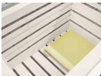
Komora wypalania grzana z pięciu stron
