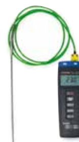
Miernik temperatury do RAKU 100, łatwy w obsłudze, czujnik temperatury NiCr-Ni, wskazanie w zakresie 20 - 1200 °C, możliwość podłączenia drugiego czujnika z przetwarzaniem wskazania
